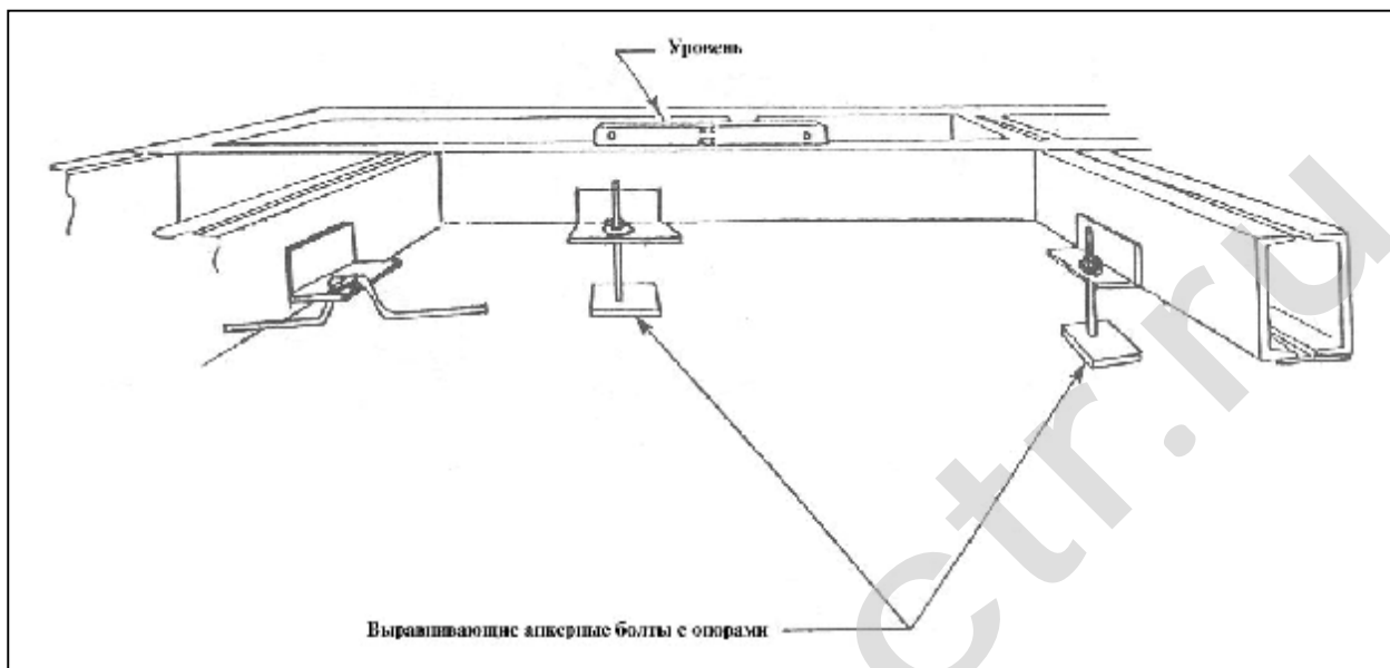
Уровневая линейка. Уровневые и анкерные опоры.
